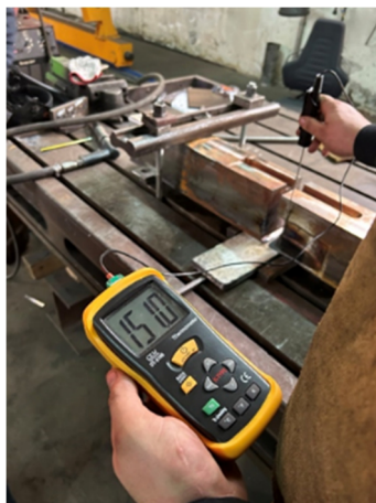
Slika 3. Kontrola temperature predgrevanja
