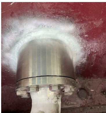
Slika 5. Penetrantska kontrola zavarenog spoja nosača kočione mlaznice
