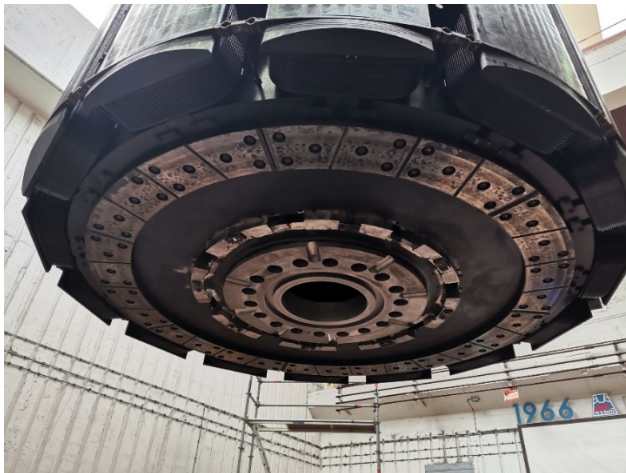
Slika 4. Izgled rekonstruisanog oklopa rotora
