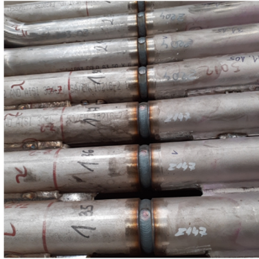
Slika 3. Zavareni sučeoni spoj na unutarnjoj komponenti kompozitne cijevi 16Mo3 koja nosi tlak na prednjem zidu ložišta u radionici ATEP-a
