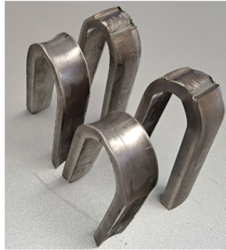
Slika 5. Ispitivanje zavarenog spoja savijanjem na lice i korijen unutarnje komponente kompozitne cijevi (16Mo3)
